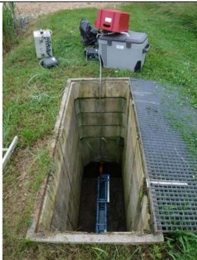
Point de mesure sortie équipé d'appareils portables
